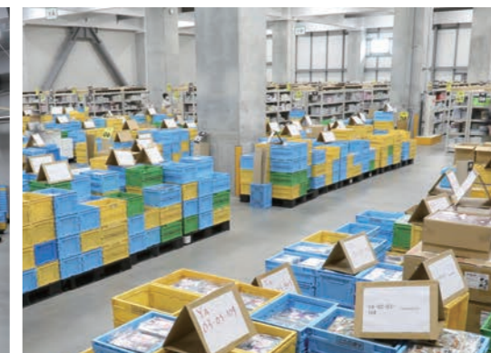
多品種・小ロットを扱う同社の物流条件に合わせて、ピン(コンテナ)高さが低いタイプ220Binを採用。約500坪に42,080ピンを格納することができる。
