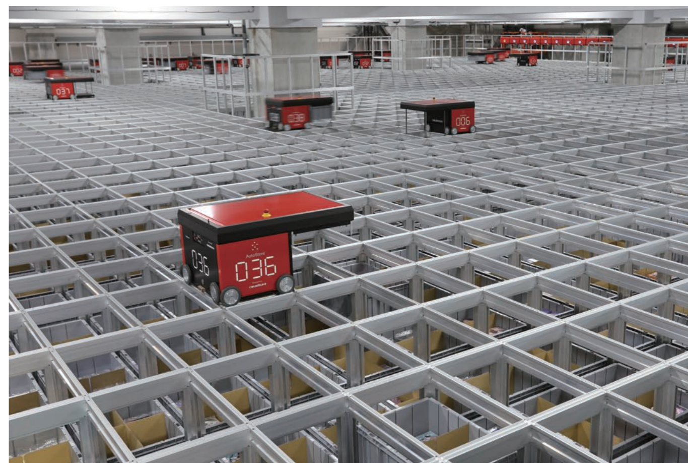
多品種・小ロットを扱う同社の物流条件に合わせて、ピン(コンテナ)高さが低いタイプ220Binを採用。約500坪に42,080ピンを格納することができる。
