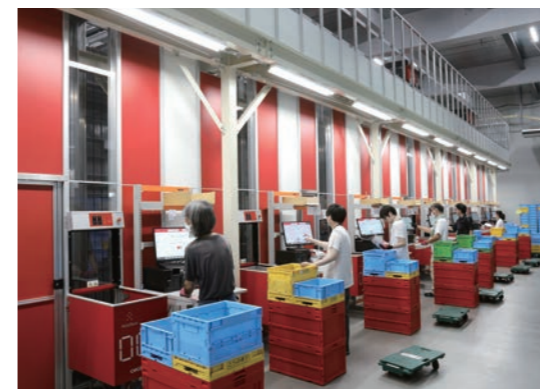
多品種・小ロットを扱う同社の物流条件に合わせて、ピン(コンテナ)高さが低いタイプ220Binを採用。約500坪に42,080ピンを格納することができる。
