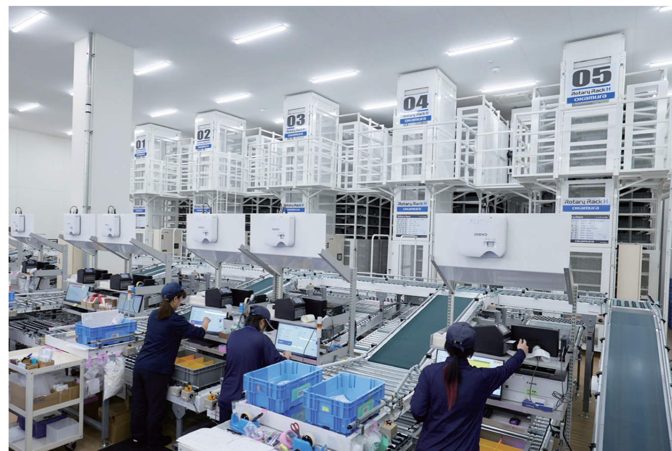
部品管理(ストック)エリアには、5基のロータリーラックHを設置。天井高6mの空間を活かし、面積あたりの部品在庫量が大幅増強された。
