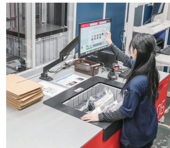
写真 右上/オートストア導入前は平棚保管で運用しており、入出庫時はスタッフが歩きまわって保管場所を探していた。 写真 右下/オートストアでの入庫。スタッフは歩き回ることなく定点で作業が完了。オートストアは商品をフリーロケーションで保管するため、ロケーション管理業務も削減できる。
