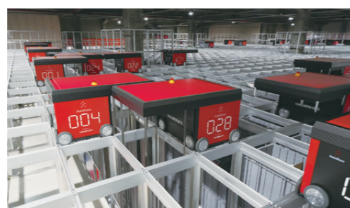
出庫ピーク時、カーセルポートの上部に次々と集まるロボット。34台のロボットが稼働している。
