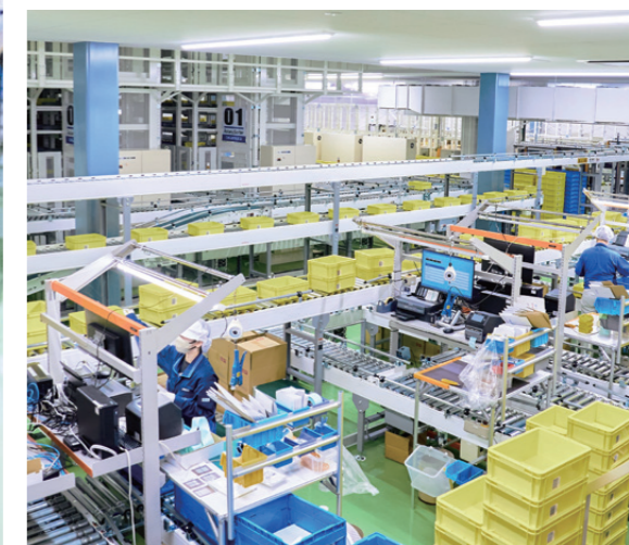
写真 右上/工場で完成した商品をコンベヤで入庫、コンテナも段ボールもそのまま入庫することが可能。 写真 右下/ピッキングエリアは将来を見据えて最大6ステーションが設置されているが、GTPシステムを採用し、現在の物量では3ステーションで時間内に作業が完了。
