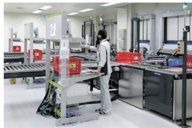
自動倉庫から出庫された血液製剤の検品、納品伝票発行作業
