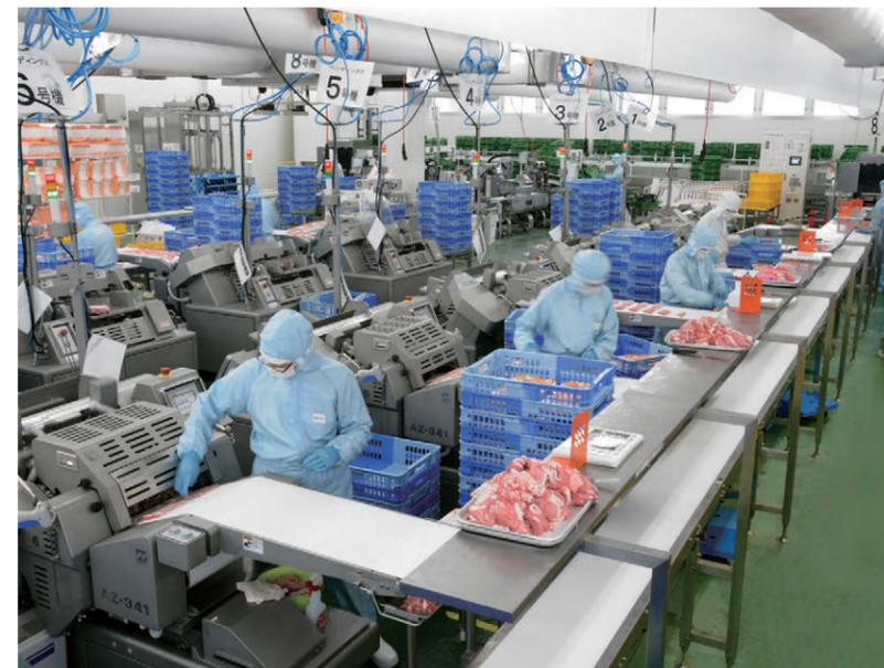
生産加工はベンディングスライサーなどの最新鋭の機器を導入。包装、計量、値付けも自動化され、作業の効率アップ、品質の安定化が図られています。
