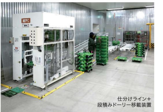
仕分けライン+段積みドローリ移載装置
