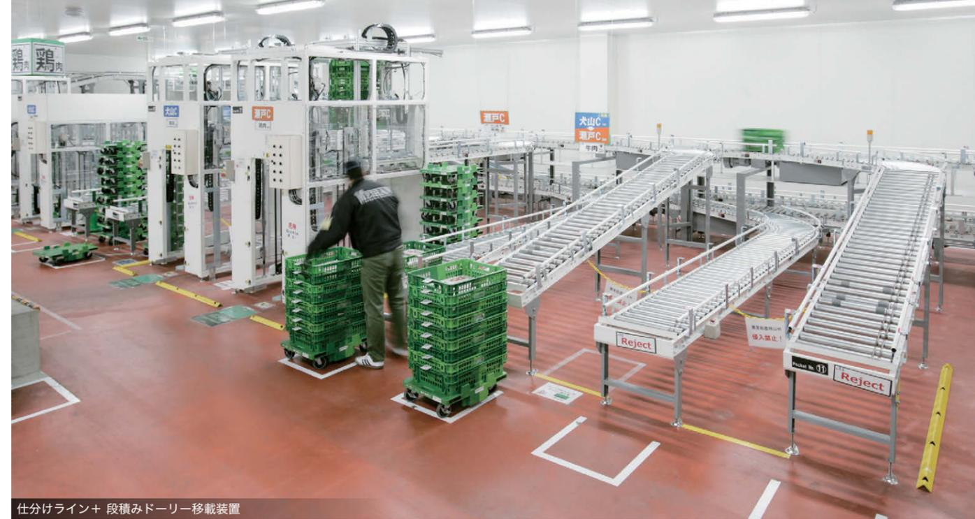
仕分けライン+ 段積みドローリ-移載装置
