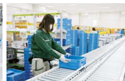
品目コードラベルを貼付けたオリコンをコンベヤラインに投入して、生産ライン別アソートエリアへ搬送。
