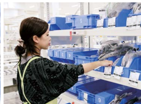
種まきするロケーション間口は、モニター画面とラック間口上のデジタル表示器で作業者に知らせ、素早くミスのない作業が行えます。
