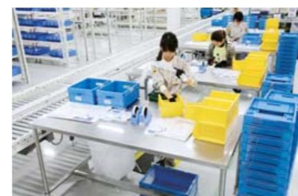
在庫からピッキングしてきた部品を小分け袋詰めし、オリコンに投入。
