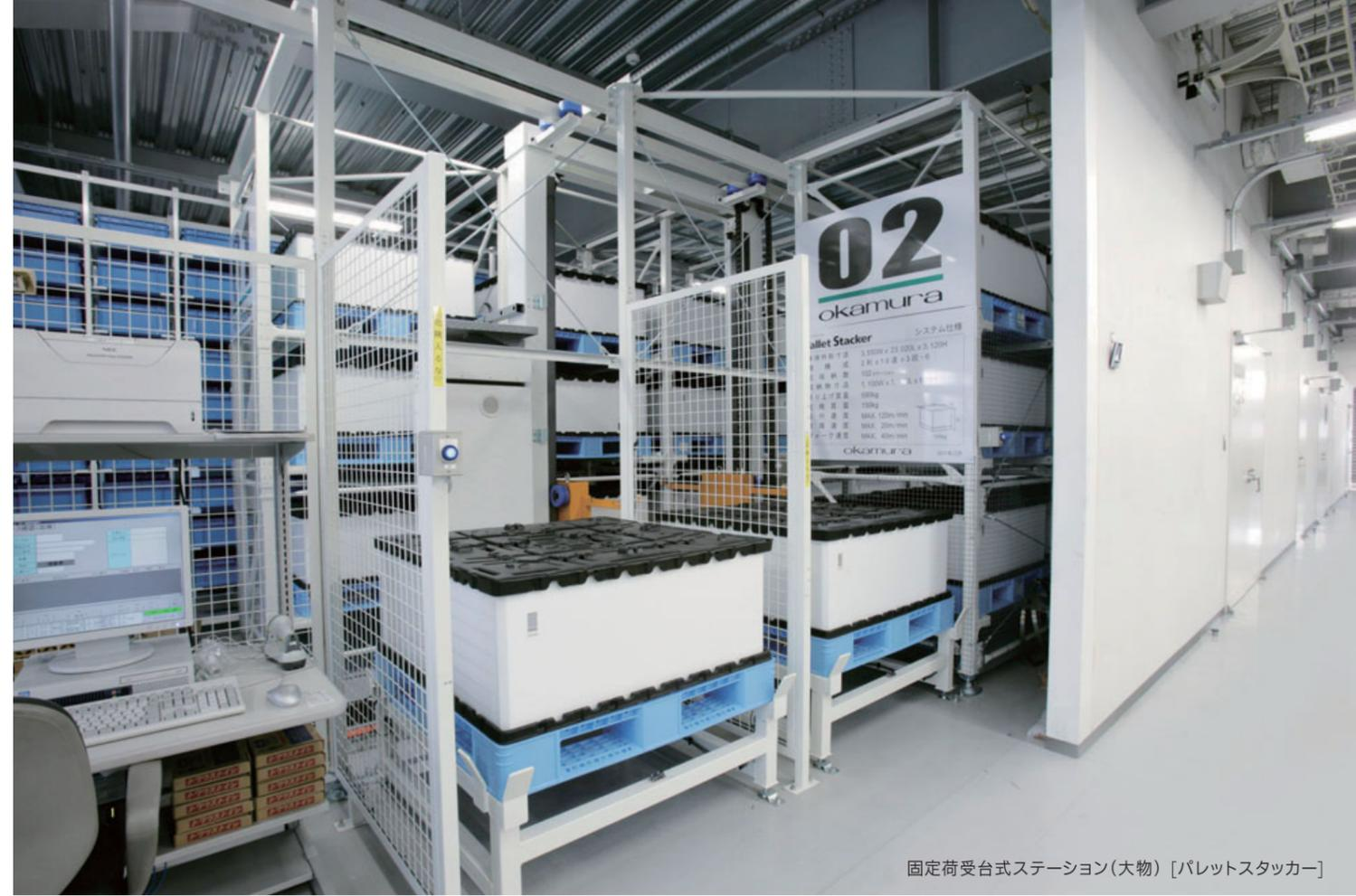
一ヶ所で連続して入出庫作業が行えるコンベヤ式ステーション(中物・小物)[バケットスタッカー]
