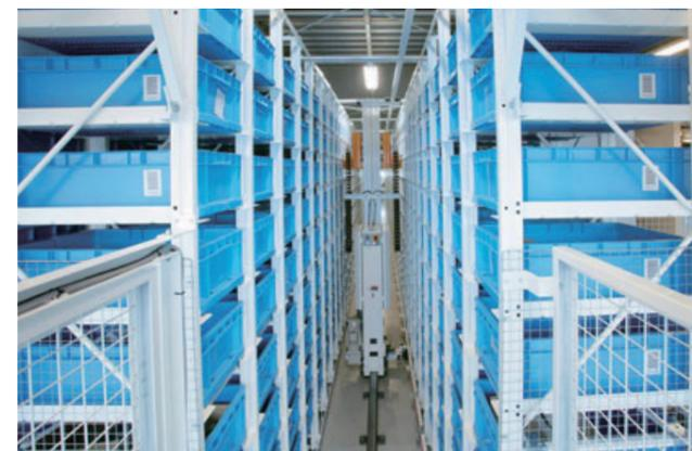
部品(材料)をサイズによって小物・中物・大物に分けて、それぞれ専用のコンテナ(中物・小物)、パレット(大物)に収納。3基の自動倉庫を並列配置し、省スペースで高密度保管しています。出庫(品揃え)と入庫(補充)の指示は、専用伝票のバーコードをスキャンして行い、目的のコンテナ/パレットを自動倉庫で高速入出庫します。ワークステーションに到着したコンテナ/パレットから必要な数量を出し入れし検品を行います。中物・小物用のコンベヤ式ステーションでは、コンベヤ上で一時待機(バッファ)機能が活用できるので、一ヶ所で連続して入出庫が行え、作業効率アップを実現しています。
