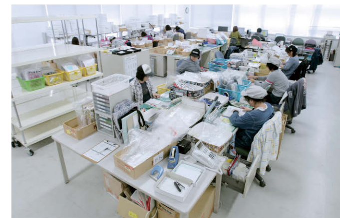
部品加工(切り離し)/検品・梱包エリアでは、ピッキングした商品(ランナー)から目的のパーツを切り離し、袋詰めします。袋詰めたパーツは、検品、梱包、荷札貼付を行い、発送しています。
