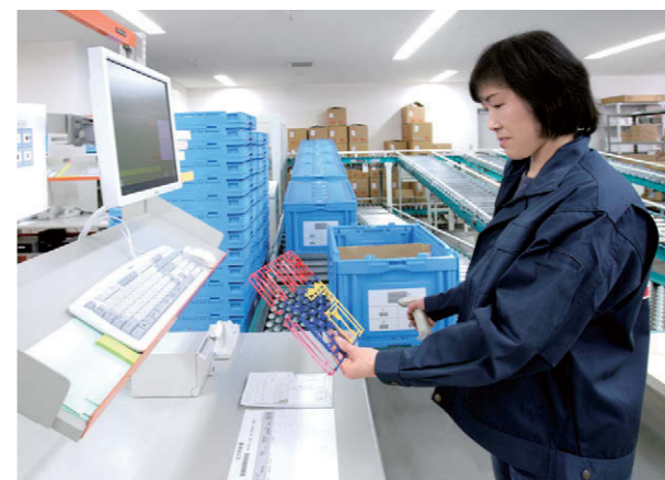
ピッキングステーションに到着したオリコンから商品をピッキングします。オリコンのバーコードラベルをスキャンし、伝票とピッキングした商品の照合を行います。
