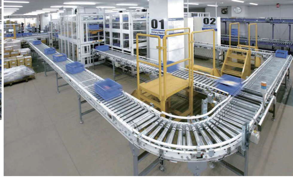
〈左〉コンベヤで搬送されてきたコンテナを自動昇降入出庫装置「オートリトリーバー」でロータリーラックH 2基へ高速入庫 〈右〉各フロアから2階の荷合わせエリアに垂直搬送機でコンテナを搬送
