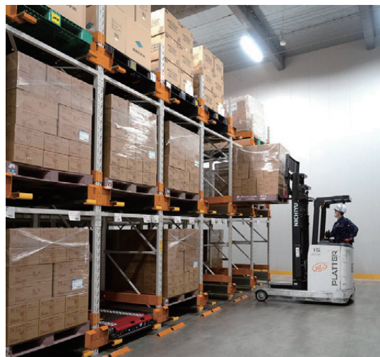
ラックの同一ロケーションで、パレット品の入出庫を次々と連続して行えるため、煩雑な荷繰り作業を大幅に削減できます。
