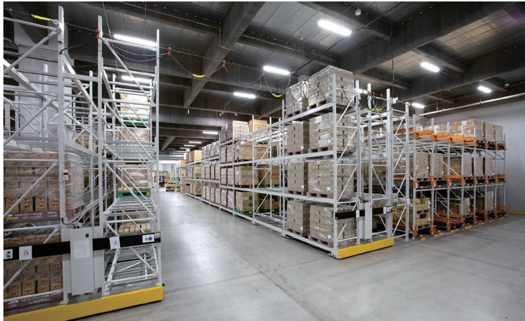
倉庫区画内の両端にサイビスターを配置、中央部はラック移動が可能な電動パレットラックを配置し、区画を通り抜けるため通路スペースを確保。
