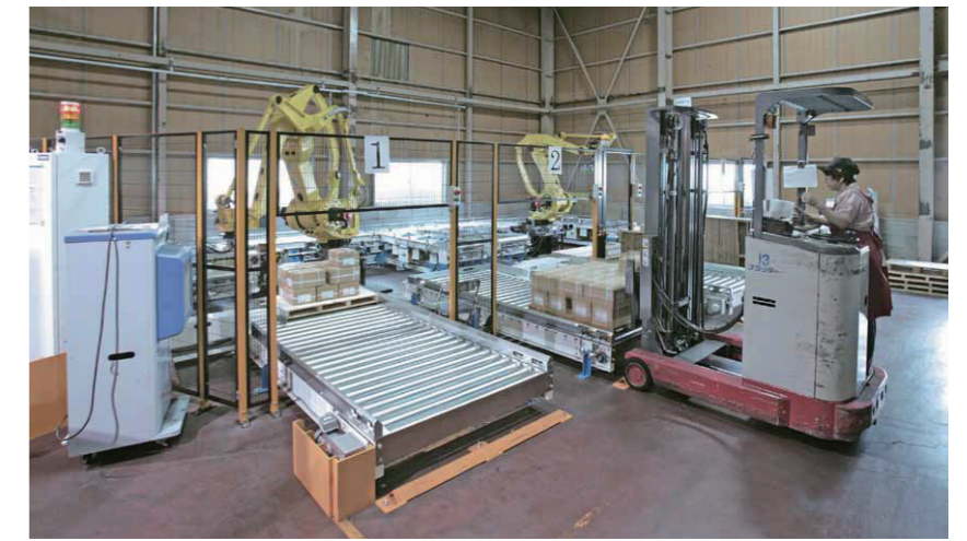
パレタイズロボットは2台導入、製品別に積み付けを行います
