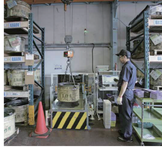
入庫の様子。工場から入荷された製品入りのドラム缶は天井クレーンで新規入庫ラインに載せてパレットスタッカーに格納
