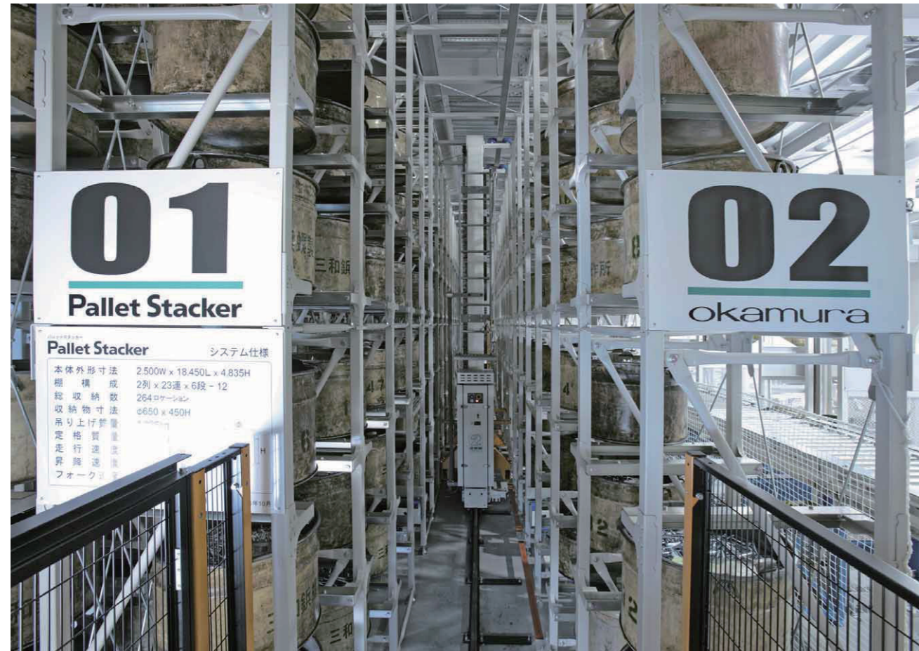
〈左〉重量物の入出庫を自動で行うパレットスタッカー。〈下左〉ドラム缶から払い出されたねじは数量を計量し、段ボールに小分け梱包。〈下右〉箱詰め後はコンベヤラインに流すだけで自動梱包が完了
