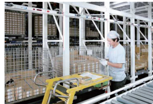
出荷オリコン搬送ラインの停止ポジション (シグナルタワー、出庫伝票 No. の表示とピッキング完了ボタン)
