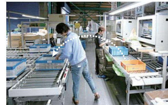
右側のロータリーラックHより出庫されたコンテナから 商品を数量分ピッキングして左側の出荷オリコンに投入。
