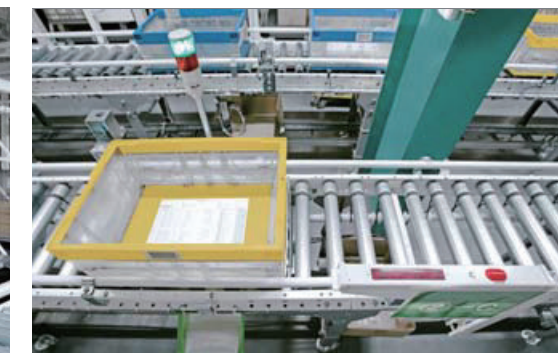
出荷オリコン搬送ラインの停止ポジション (シグナルタワー、出庫伝票 No. の表示とピッキング完了ボタン)
