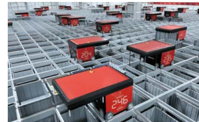
自動倉庫・ロボットストレージシステム
