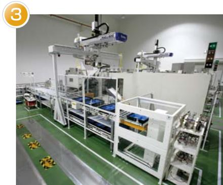
成型機から取り出した製品をコンテナに投入
