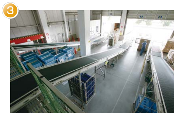
3 入庫用コンベヤ
