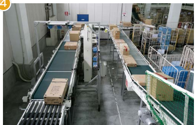
4 全方向バーコードリーダー 入庫ラインとリターン用バイパスラインの合流部
