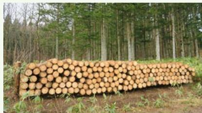
径級の違いによる材の特性を検証するために切り出した丸太（直径24cm×3.5m・180本）
