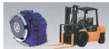
フォークリフトに搭載されたトルクコンバータ
