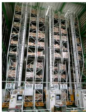
スタッカークレーン式自動倉庫
