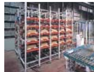
モーターなしで垂直搬送し、省エネルギーを実現した物流棚
